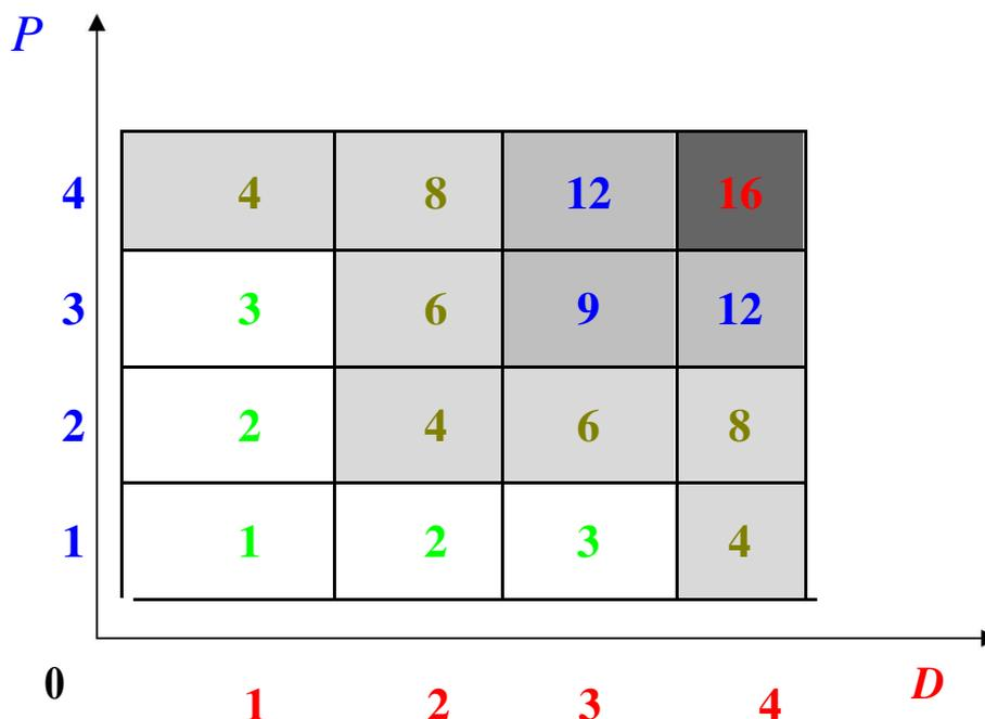
Fig. 2 : Esempio di matrice dell' Indice di Rischio
